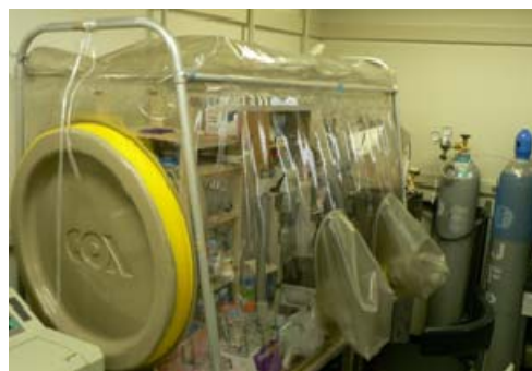
図 3 嫌気チャンパー。この中は窒素、水素(1%)、二酸化炭素(5%)で充填されており、O 2 レベルが 1ppm 以下という嫌気状態が保たれている。DPOR、COR はニトロゲナーゼ同様、酸素感受性の酵素であるため、粗抽出液の調製、蛋白質の精製、活性測定など全ての操作をこの中で行なう。
